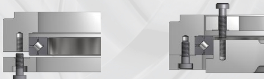
Befestigung von Kreuzrollenlager mit Klemmringen
